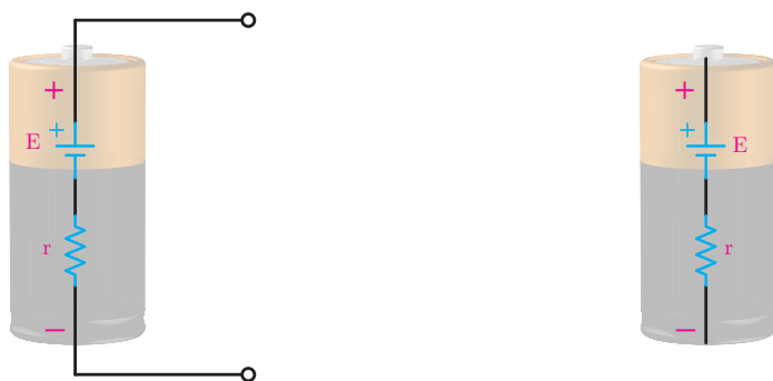
شکل ۶۶- مدار الکتریکی باتری
